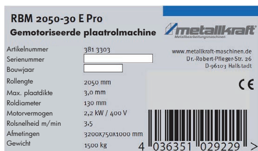
Afb. 3 Naamplaat en CE markering op RBM E PRO
