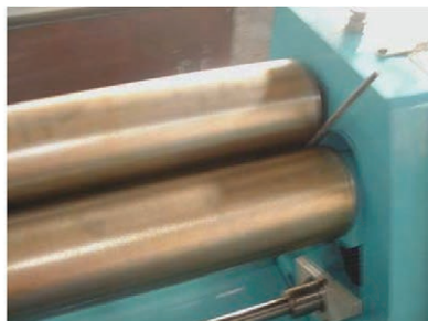
Afb. 18 Het parallelisme van de rollen controleren
